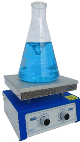
Slika 7. Primjer magnetske miješalice (izvor: https://www.mrclab.com )
