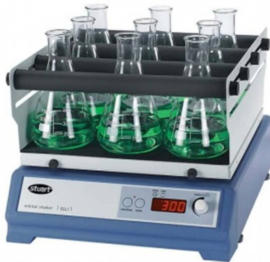
Slika 9. Primjer treskalice s uključenim dodacima za držanje laboratorijskih flaša (izvor: https://www.gammascientific.com.my/products/product/51-laboratory-shakers )
