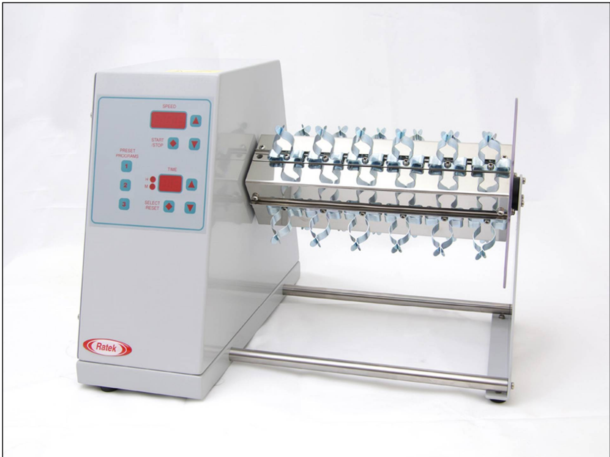
Slika 8. Primjer rotacijske mućkalice većeg kapaciteta (izvor: http://www.ratek.com.au/products/RM4-Rotary-Mixer.html )
